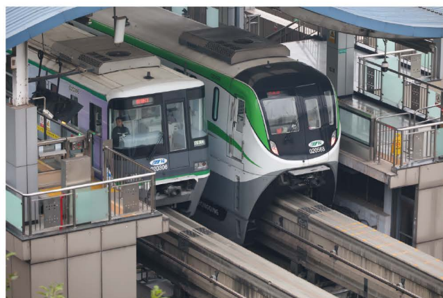
重慶軌道交通 2 号線 QKZ2 型（左）と新型車両 CCD（右）。QKZ2 型は大阪モノレール営業車両がベースになっており、その外観は瓜二つ。
