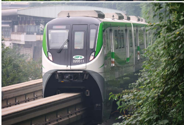
重慶軌道交通 2 号線に導入された新型車両 CCD。導入される全編成は 8 両編成となっており、最大定員は 1800 人に達する。これはモノレールとして世界最大の収容能力を誇る。
