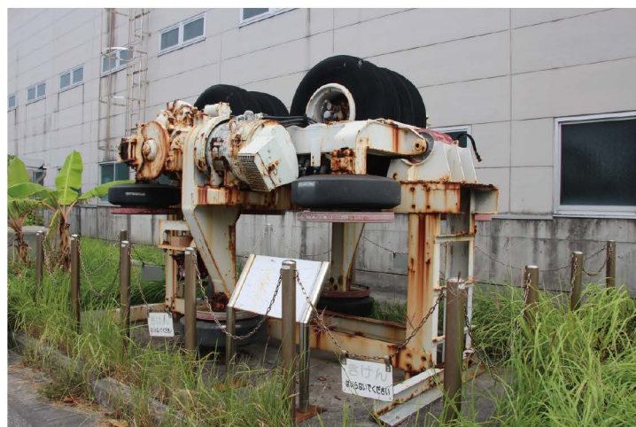
東京モノレール 500 形から採用された 2 軸ボギー台車、画像は沖縄都市モノレール車両基地内で展示されていたもの。
